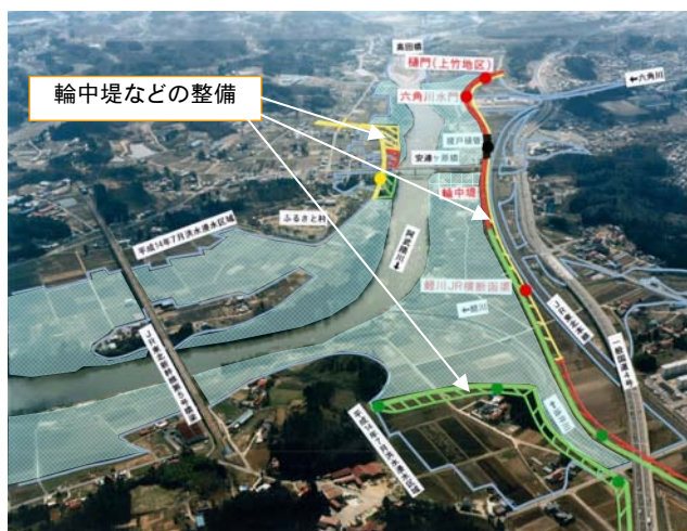
整備後も氾濫域（網掛け部分）が残り遊水機能を確保 【出典：福島河川国道事務所 資料】
