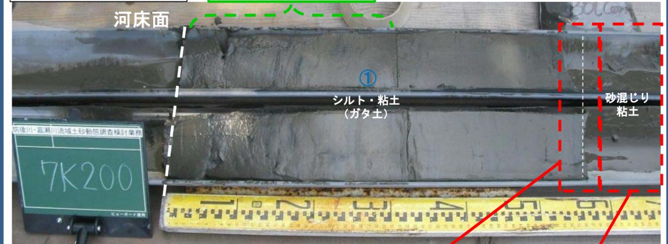
表層はシルト・粘土（ガタ土）であり、これより下層に砂混じり粘土を確認。さらに下層は石を含む砂礫であったため、コア採取時に材料が抜け落ち採取不可
