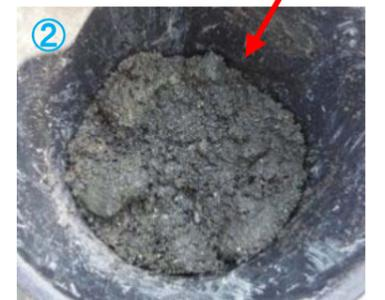
ダイバーによる直接採取試料石を含む砂・礫（石が含まれコア採取不可）
