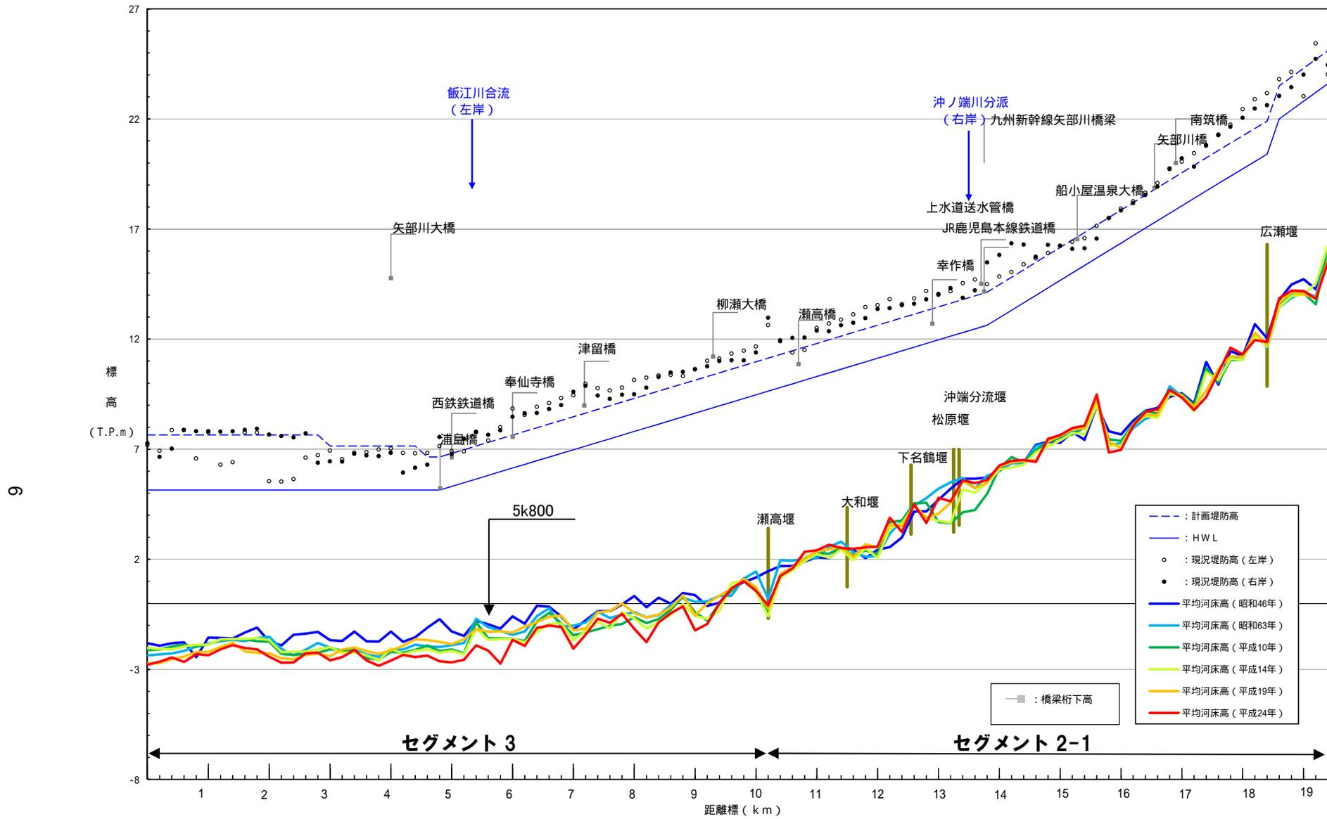
図 2-2 (1) 矢部川平均河床高縦断図 (昭和 46 年 ~ 平成 24 年)
