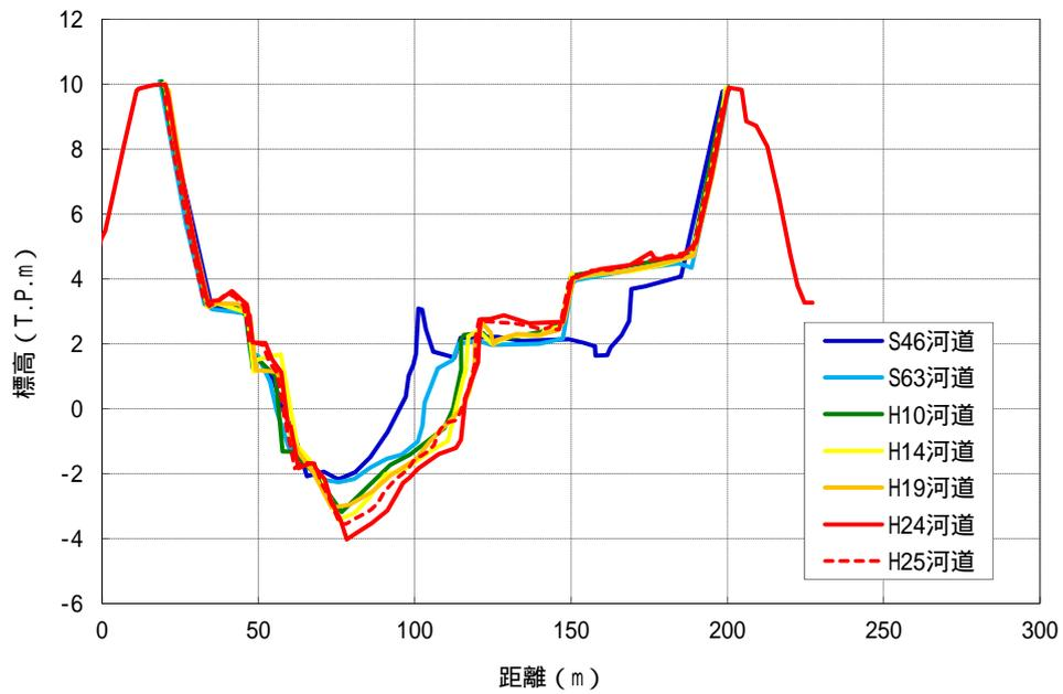
図 2-2 (3) 横断面図 (矢部川 7 k 200 : 出水後の回復状況)
