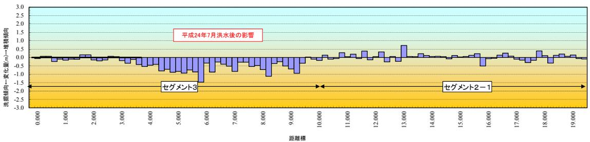
図 2-1 矢部川平均河床高変化量の経年変化図 (昭和46年～平成24年)
