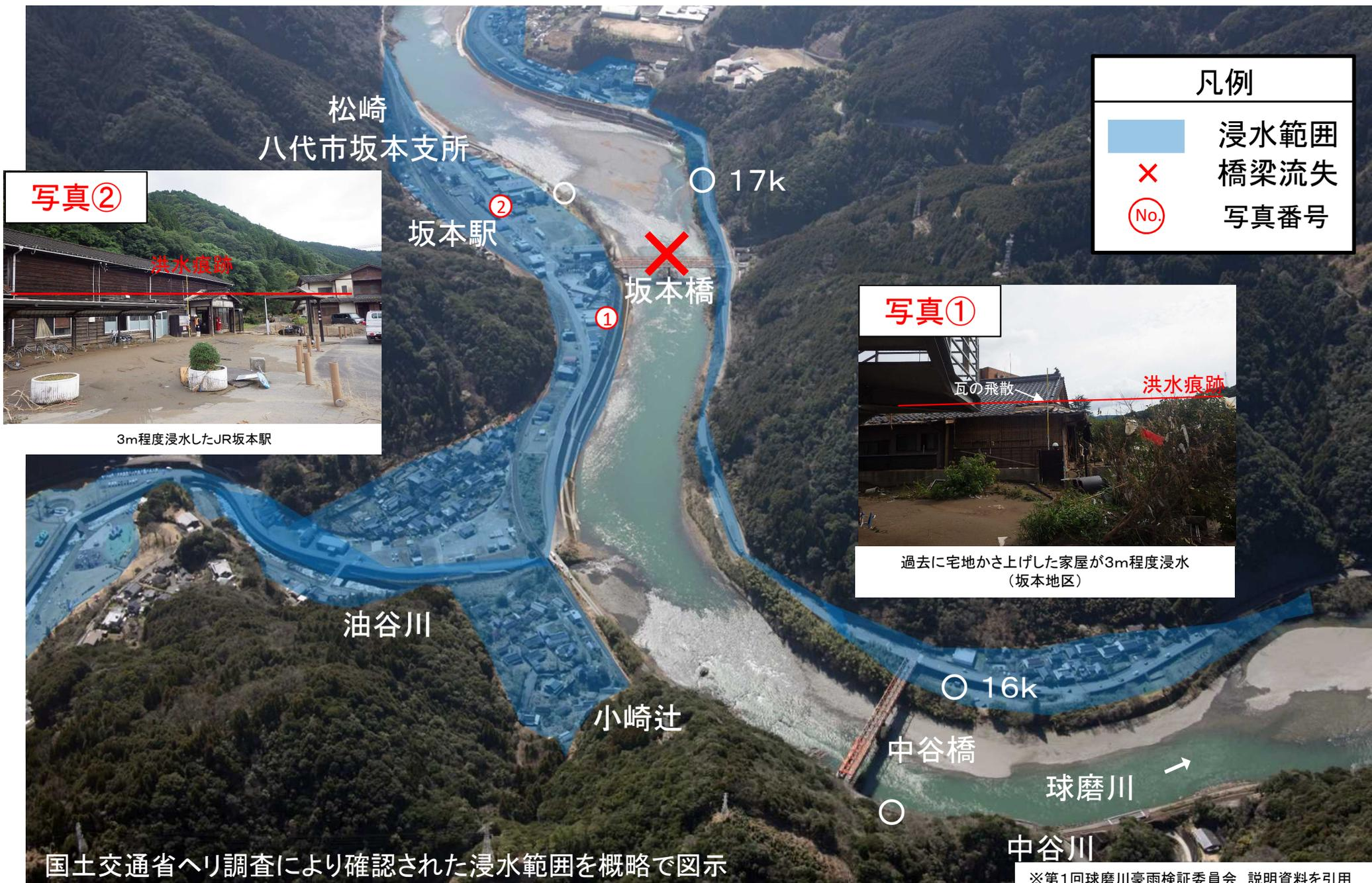
○中流部で山間狭窄部の八代市坂本町では、宅地かさ上げを実施した箇所においても浸水し、洪水流により橋梁上部工が流失するなど未曾有の被害が発生。
