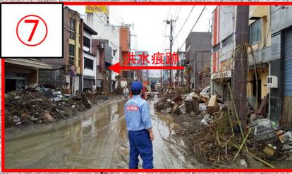
高さ3m付近に洪水痕跡を確認(国道445号通り)
