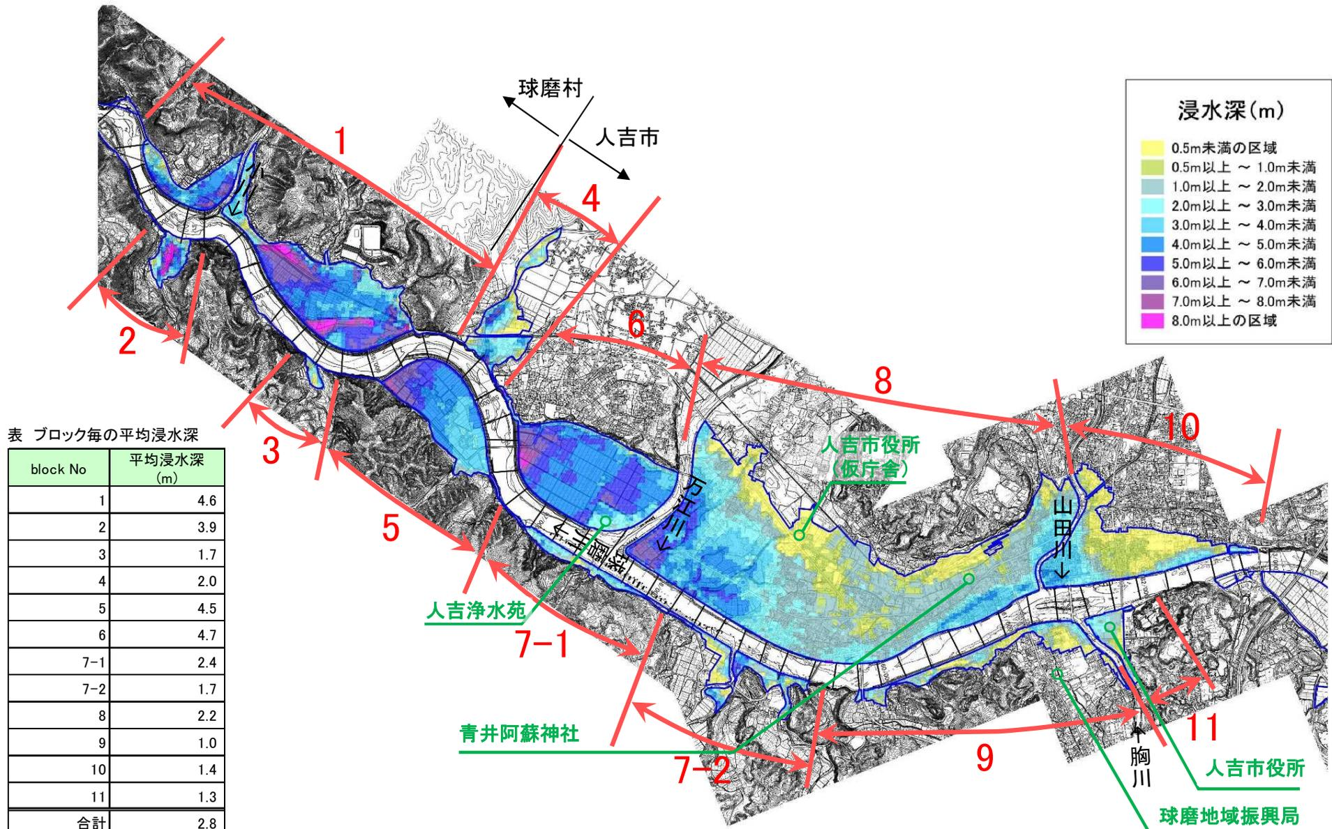
※洪水痕跡調査など浸水区域・浸水深調査結果より、今次出水の浸水深を推定。 ※第1回球磨川豪雨検証委員会 説明資料を引用
