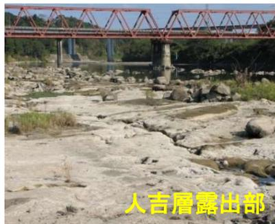
※スレーキングとは、塊状の物質(土塊や軟岩)が乾燥、湿潤を繰り返すことで、細かくバラバラに崩壊する(細粒化する)現象のことで、スレーキング試験とは人工的に24時間ずつ乾燥・湿潤を繰り返し、細粒化の度合いを確認する試験。
