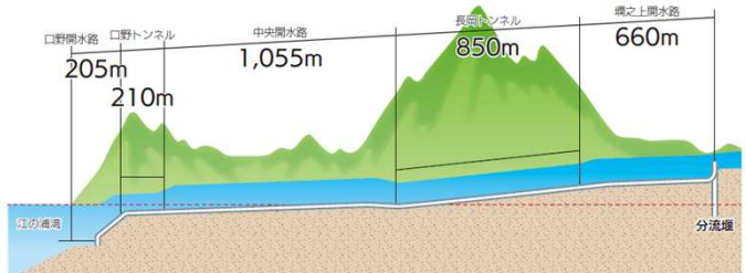
狩野川放水路縦断面図 出典：狩野川放水路工事誌
