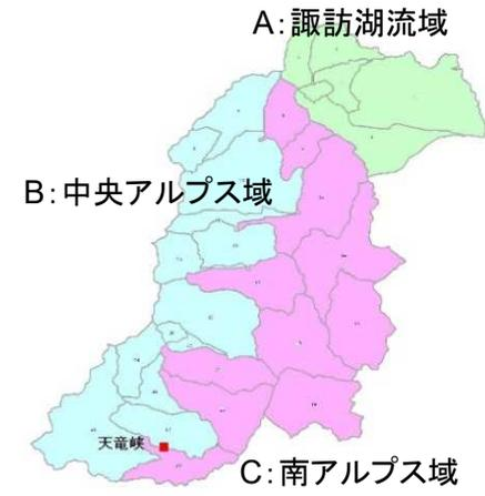
d2PDF等(将来気候)から計画規模の降雨量近傍(±20%)のアンサンブル降雨波形を抽出し、各波形について、継続時間内の小流域の流域平均雨量/基準地点上流域平均雨量を求める(基準地点上流域の流域平均雨量に対する小流域の流域平均雨量の比率)
