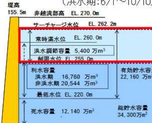
既設利水専用ダムである佐久間ダム貯水池の運用方法の変更を行うとともに、新たに洪水調節容量5,400万m³を確保
