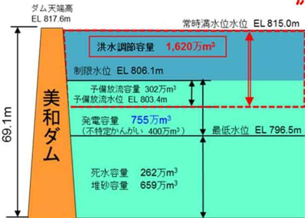
堆砂掘削・利水容量の一部振替により洪水調節容量を13,400千m³⇒16,200千m³に強化
