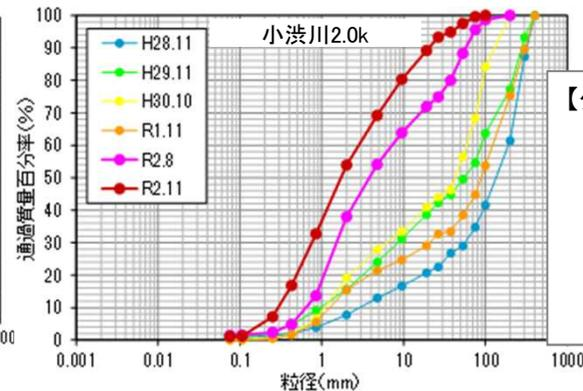
【ダム下流の河床材料の変化(平成23年～令和2年)】
