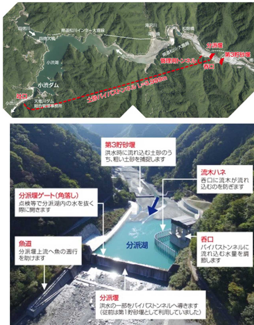
図 3-14 : 小渋ダム堰堤改良事業の整備内容
