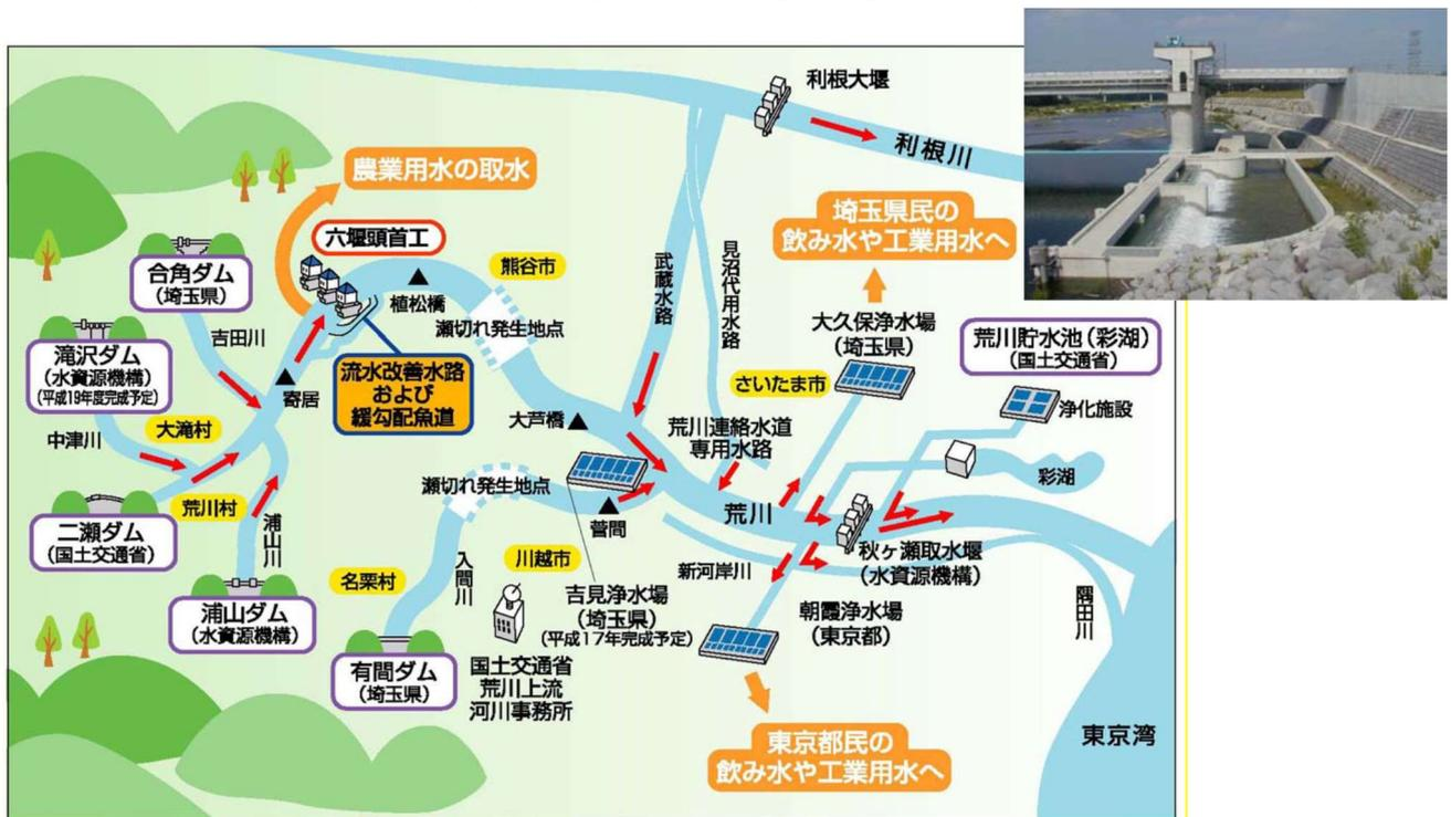
図 5-8 荒川の水の流れと主要施設と六堰の流水改善水路の写真
