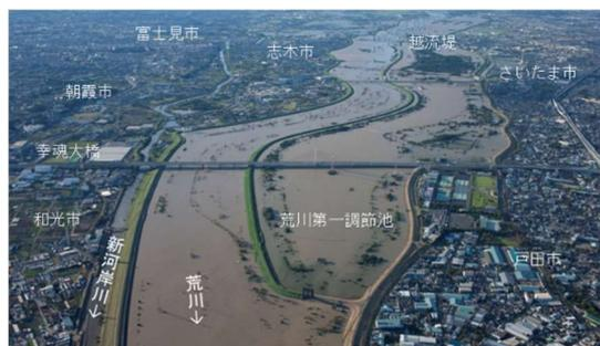
写真 4-15 荒川第一調節池での洪水調節状況
