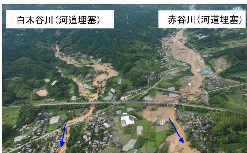
図 2-2 平成 29 年 7 月豪雨時の赤谷川、白木谷川の被害状況
