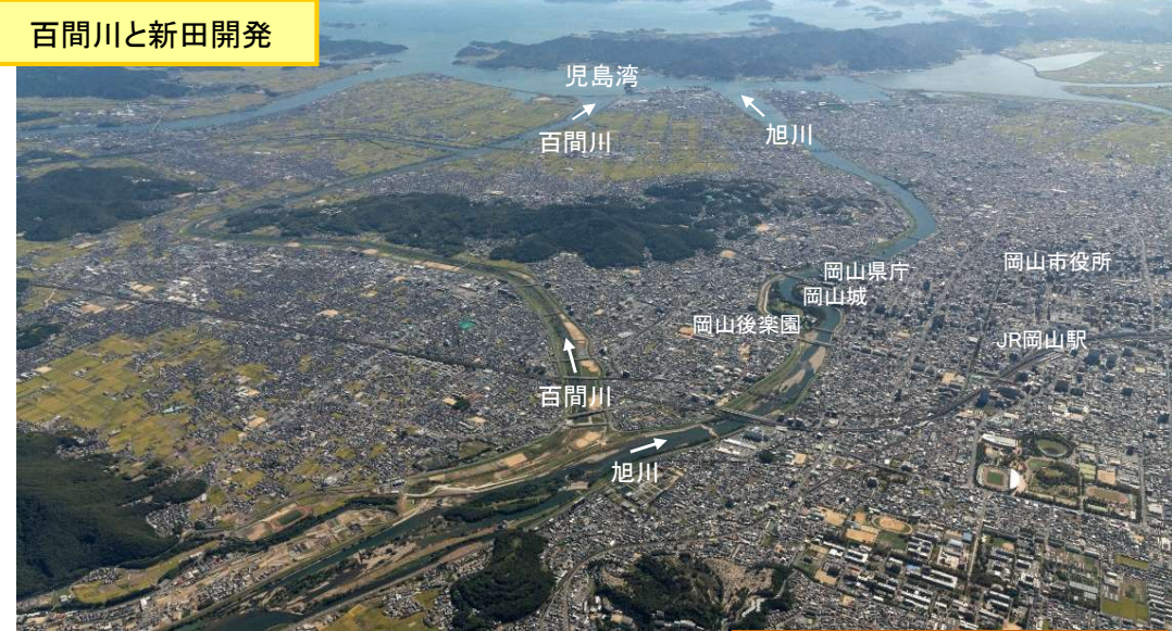
百間川の整備により、治水（岡山城下の浸水被害の軽減）と新田開発（人口増加による食料増産対策）を両立させた
