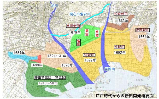
百間川の整備により、治水（岡山城下の浸水被害の軽減）と新田開発（人口増加による食料増産対策）を両立させた
