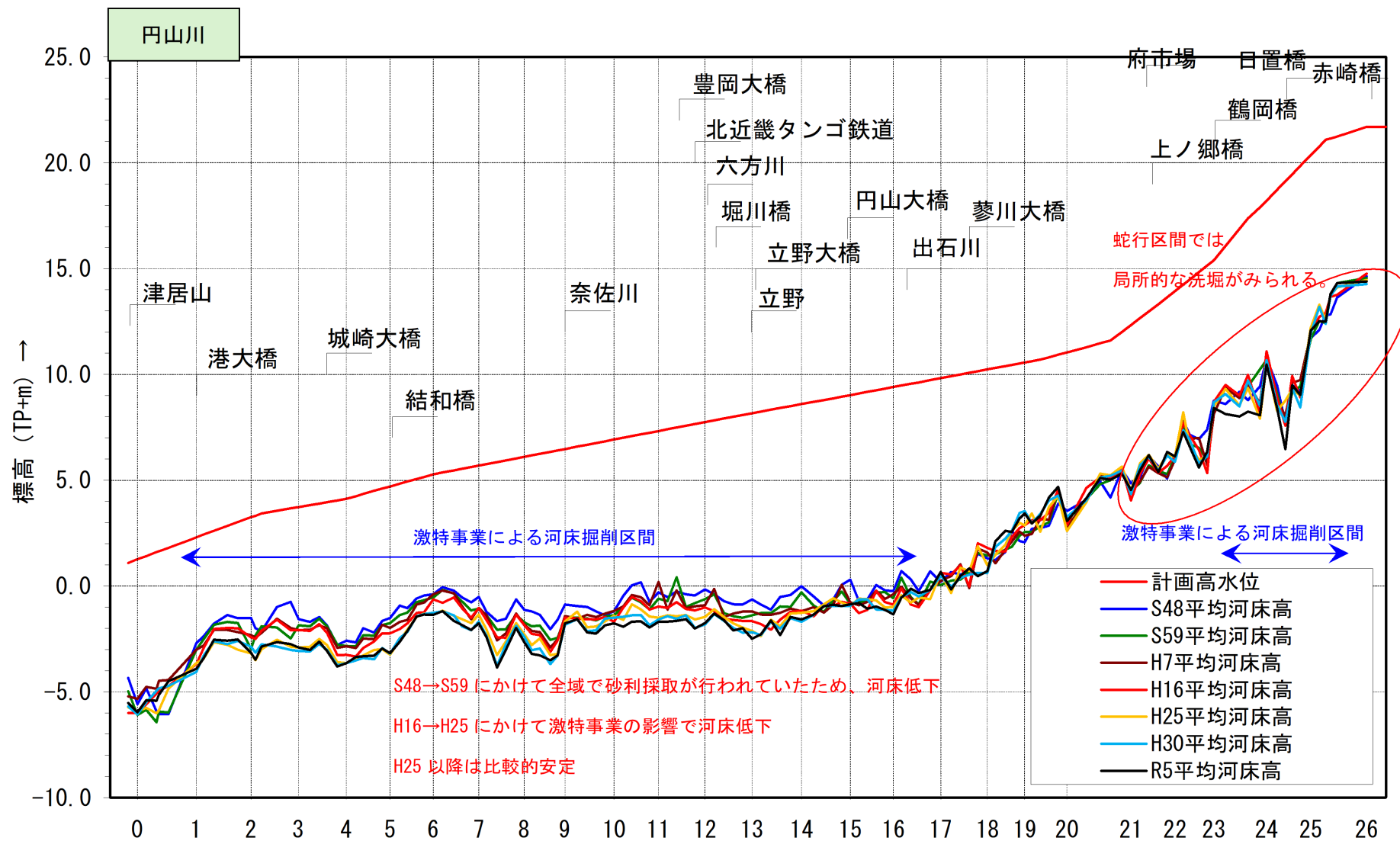
図 8-4 平均河床高縦断面図（円山川）
