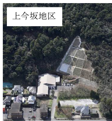
図 2-5 急傾斜地崩壊対策事業（鹿児島県）
