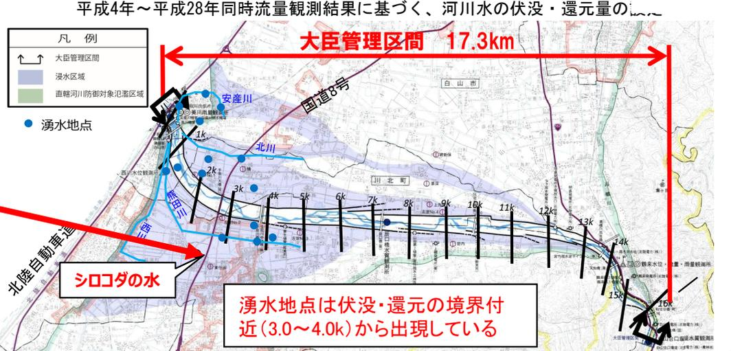
計画水収支における伏没・還元傾向の設定状況と、手取川ダム完成(昭和56年)後の同時流観結果(平成18年11月5日)との比較
