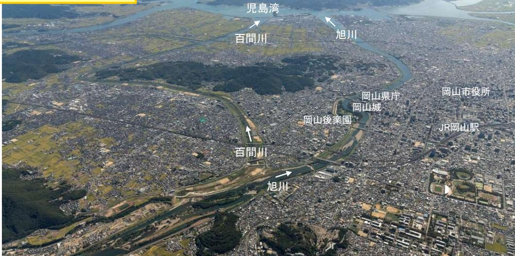
百間川の整備により、治水（岡山城下の浸水被害の軽減）と新田開発（人口増加による食料増産対策）を両立させた
