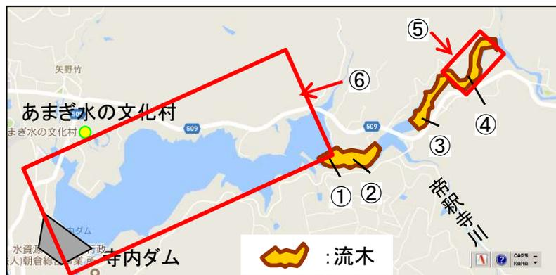
平成29年7月5日出水により、約10,000m<sup>3</sup>の流木等を捕捉したと推定(年平均は120m<sup>3</sup>程度)
