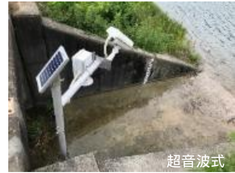
ため池での水位計設置状況
