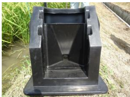
田んぼの排水ますに設置する調整装置
