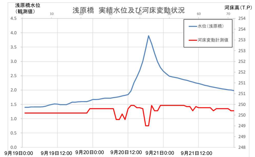
浅原橋観測水位と河床変動の状況
