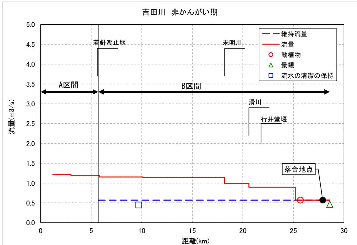
図 6.2 吉田川 正常流量縦断面図
