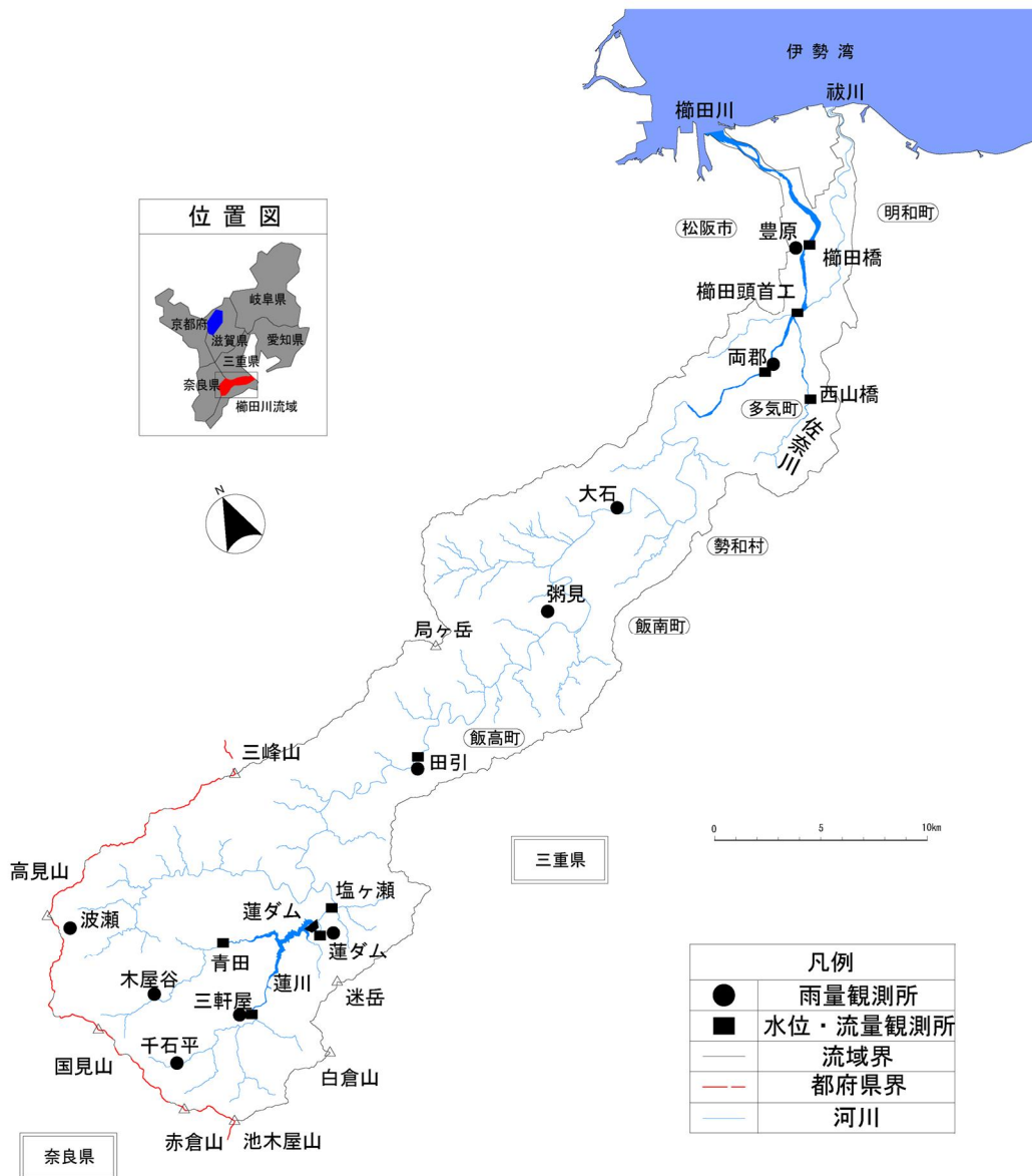
図9-2 櫛田川水系雨量・水位・流量観測所設置位置図
