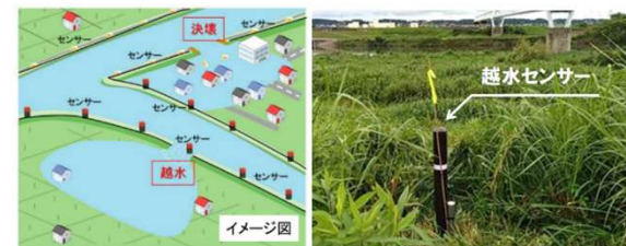
▲堤防に設置した越水・決壊検知センサーが、越水や決壊箇所を検知し、情報を送信
