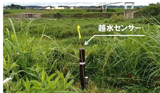
図 9-7 越水・決壊センサーの開発・整備イメージ図
