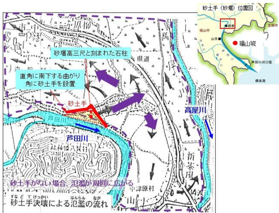
図 4-8 砂土手（砂堰）決壊による氾濫の流れ
