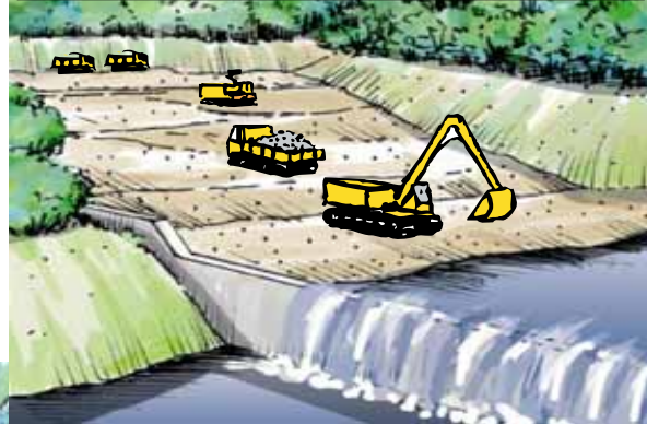
貯砂ダム(貯めて取る)
