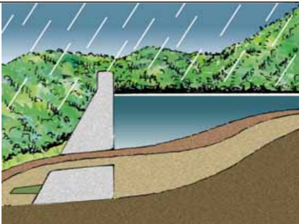
排砂ゲート(土砂フラッシュ)
