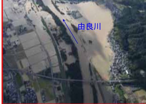
私市地区で堤防未整備区間から氾濫
