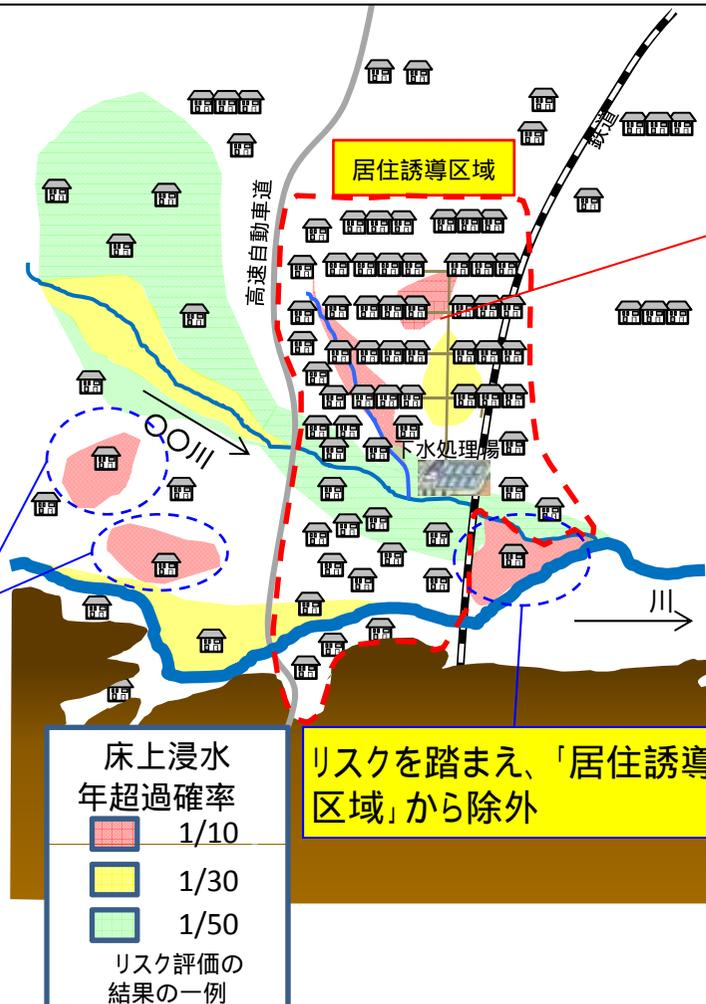
リスクが高い箇所であるものの、既に都市機能や住宅等が集積しており、居住誘導区域等に指定せざるを得ない地域は、河川改修、下水道整備、雨水貯留浸透施設整備などを実施することにより、水害リスクの低減を図る。
