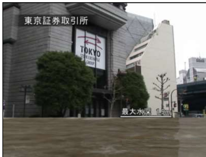
東京証券取引所 浸水状況(荒川破堤シミュレーション結果)
