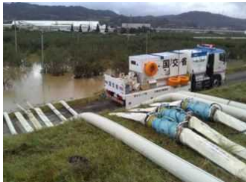
排水ポンプ車の増強
