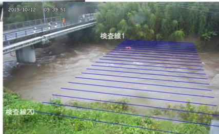
画像処理による 流速計測
