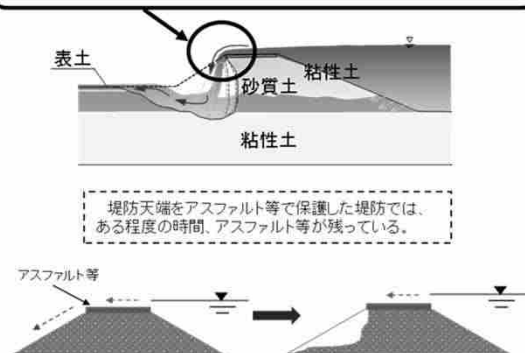
堤防天端の保護
