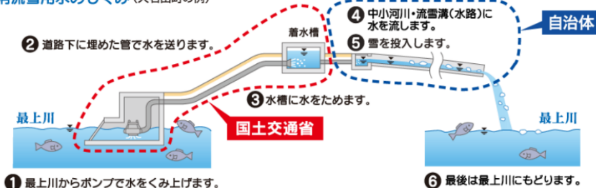
消流雪用水のしくみ（大石田町の例）
