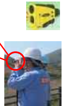
レーザー計測器の活用により容易に距離を計測 (ポール、リボンテープによる測量を不要にする)
