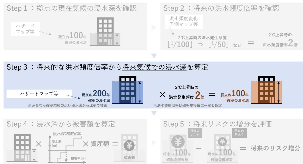
図 3-7 将来の浸水深を概略的に評価する手法
