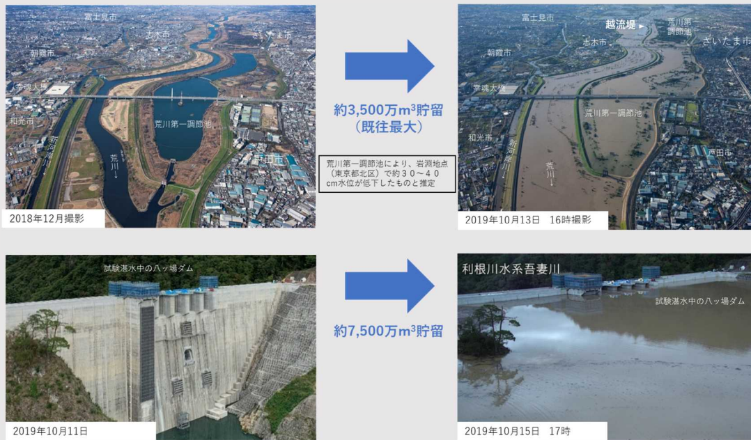
図 4-6 2019 年東日本台風における荒川第一調整池および試験湛水中のハッ場ダムの効果 72
