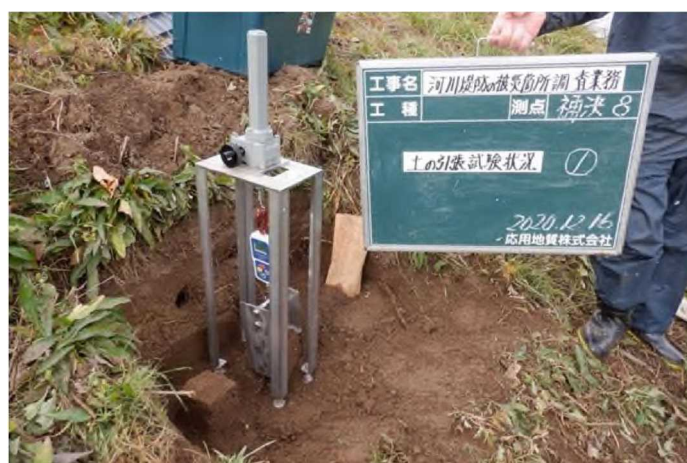
写真 2.3-5 引張破壊応力試験の様子
