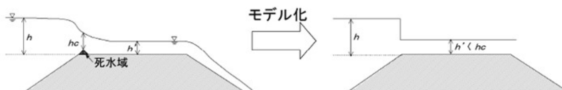
図 5.4-6 堤防天端の越水のモデル化
