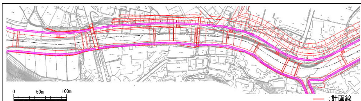
図 17 赤倉地区河道改修平面図
