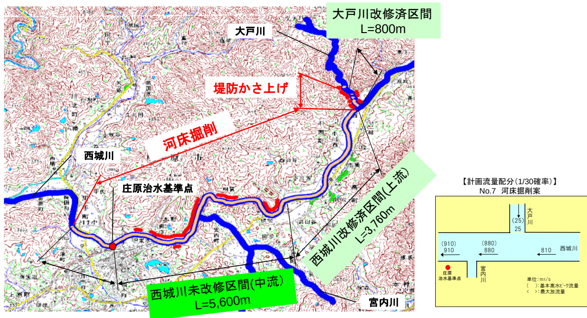
図 3.3.23 No.7：河床掘削案
