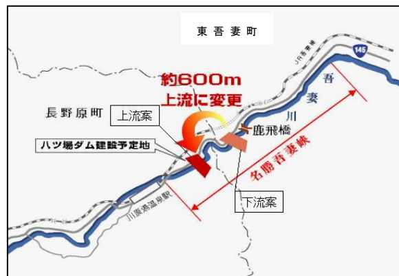
図 3-2-1 ダムサイト位置の変更状況
