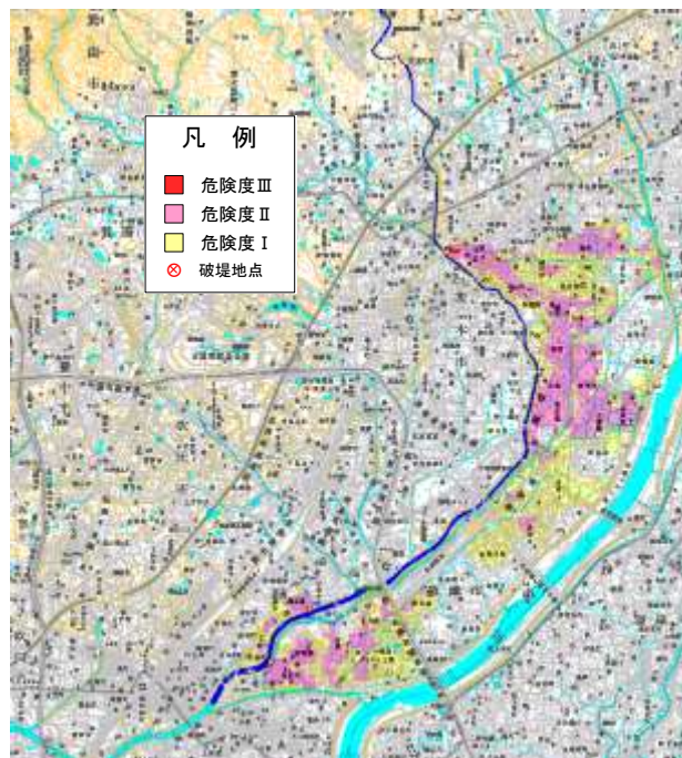
図 4.1.5(3) 1/100 対策後に 1/200 (90mm/h 程度) の降雨が発生した場合の氾濫解析結果
