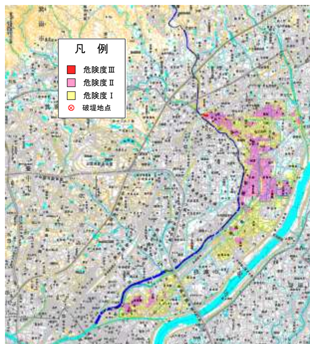
図 4.1.5(1) 1/30 対策後に 1/100 (80mm/h 程度) の降雨が発生した場合の氾濫解析結果
