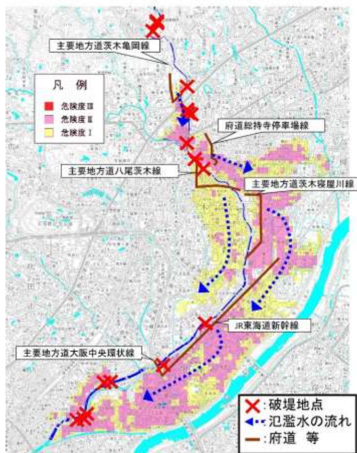
図 4.3.3 1/30 対策河道改修後に 1/100 の雨が降った場合の氾濫解析結果
