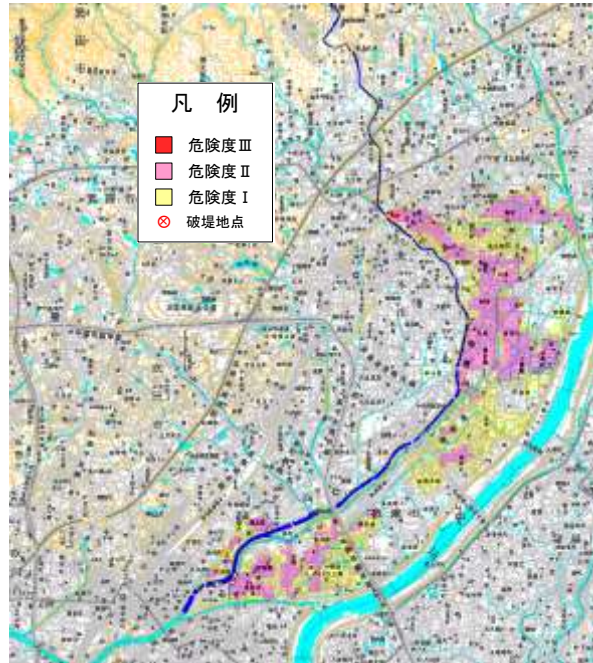
図 4.1.5(2) 1/30 対策後に 1/200 (90mm/h 程度) の降雨が発生した場合の氾濫解析結果
