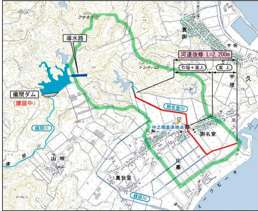
図 4-17 施設位置図 (築堤案)
