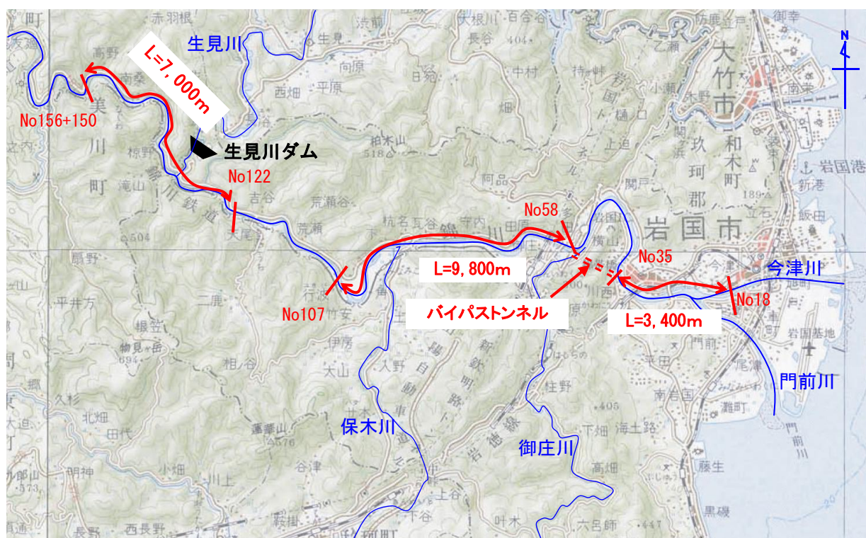
図 4.3.24 河川改修事業区間
