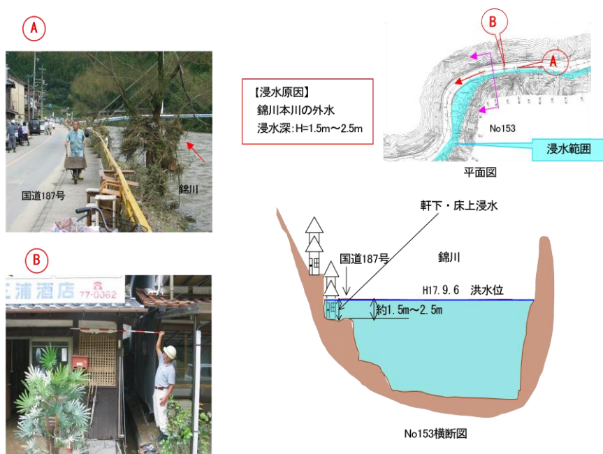
図 2.2.6 平成 17 年 9 月台風 14 号 浸水状況（美川町・南桑地区）
