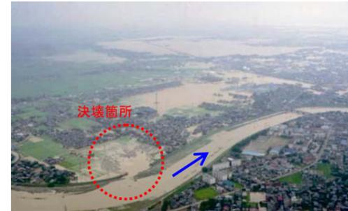
写真-1.2 H16.7.13 水害(決壊した五十嵐川、三条市)
