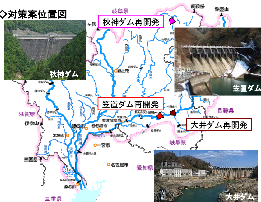
図 4.4.4 ダム再開発（かさ上げ・掘削）の概要
