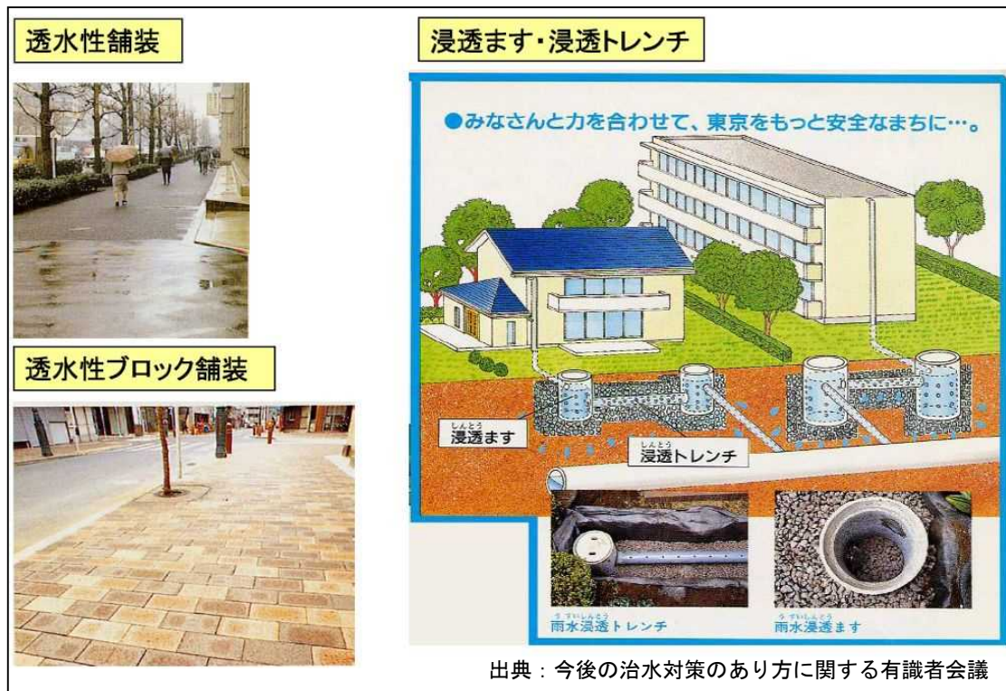
図 4.2.16 雨水浸透施設のイメージ
