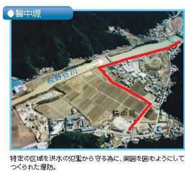
図 4.2.21 輪中堤のイメージ
