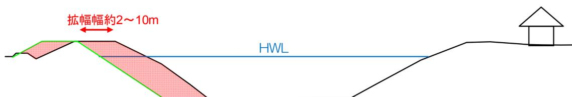
図 4.3.17 引堤のイメージ（下流～中流域）
