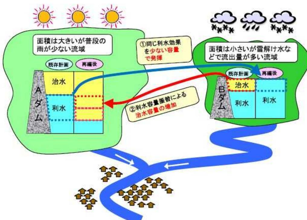
図 4.6.6 他用途ダム容量の買い上げのイメージ
