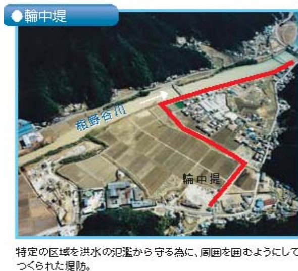
図 2.2.2 輪中堤のイメージ
