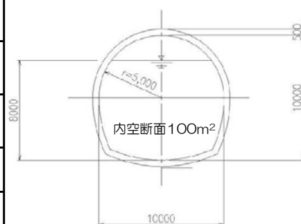
図 2.3.17 ケース 3-1 の断面形状
