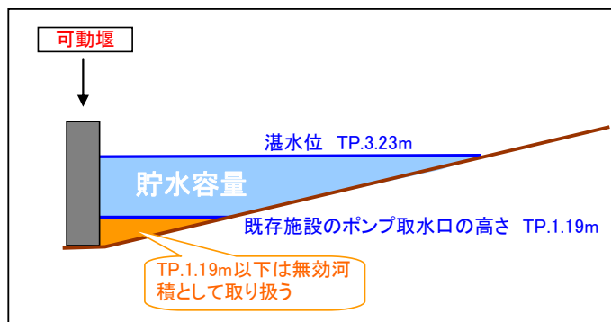
図 可動堰と河床縦断との関係
