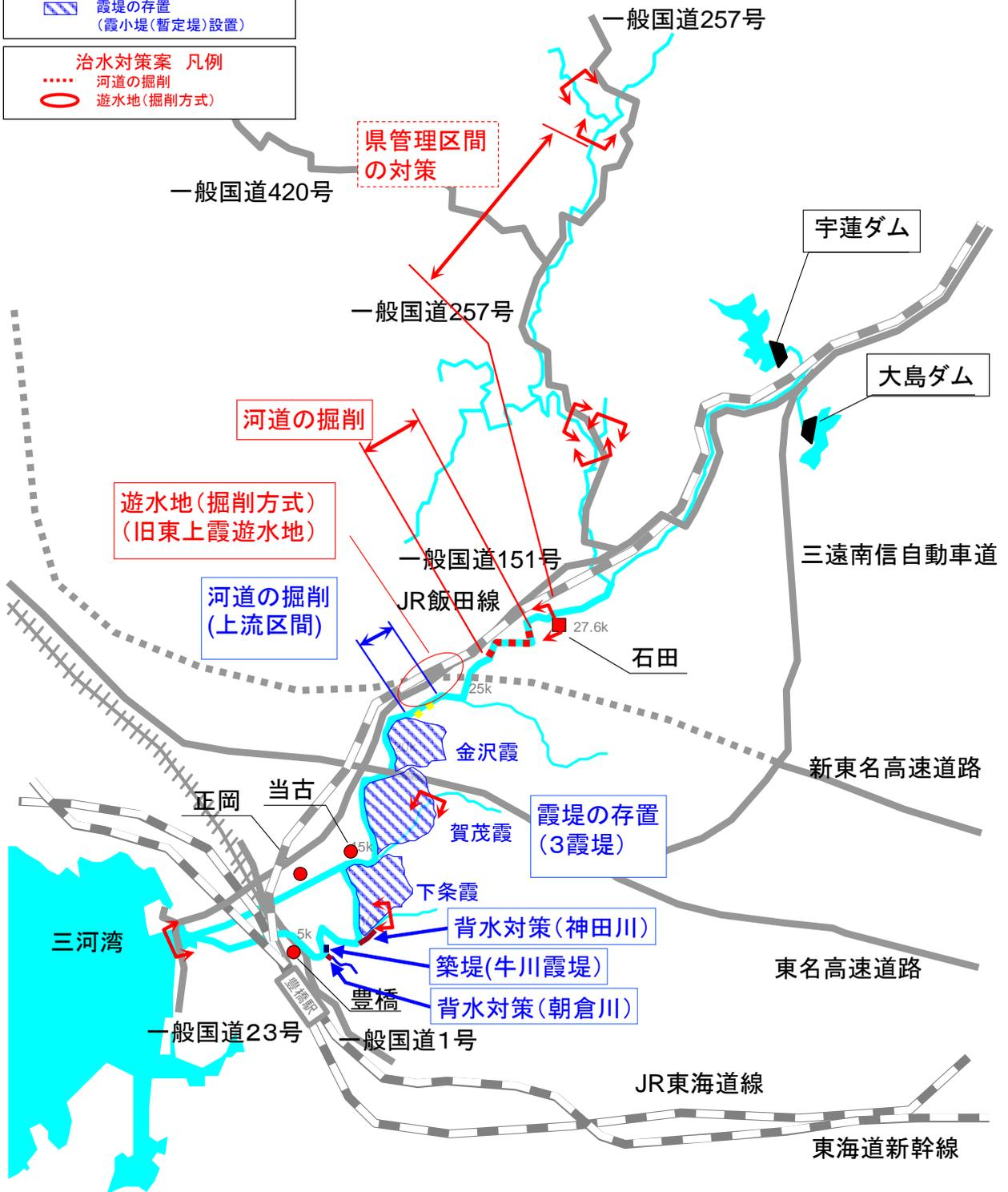
24) 治水対策案NO. 23 3霞堤遊水地（開口部変更）+河道掘削+輪中堤
