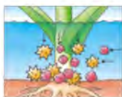
①茎との接触による沈殿効果 流水が茎と接触する際に、汚濁物質が沈殿・堆積します。ヨシの密集地帯では、沈殿の効率も高くなります。
