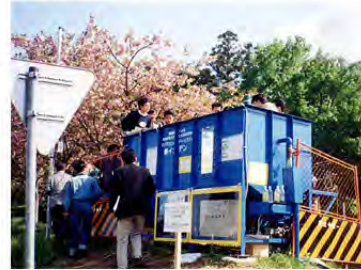
出典：高効率電気分解装置を用いた水処理装置 財団法人 茨城県科学技術振興財団 霞ヶ浦水質浄化プロジェクト http://www.i-step.org/kasumi/spread/k002.htm
