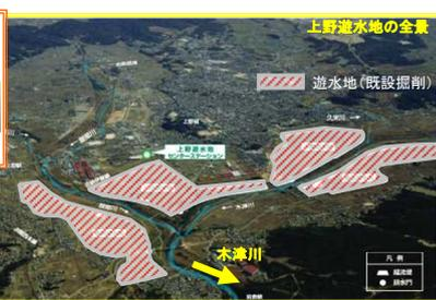
遊水地(既設掘削)：既設遊水地を掘り下げて遊水地の容量の増強を想定
